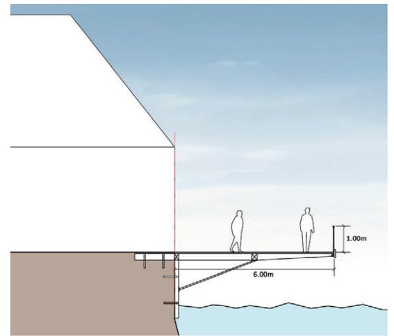
Ouvrage en encorbellement permettant de contourner le théâtre du Lavoir
